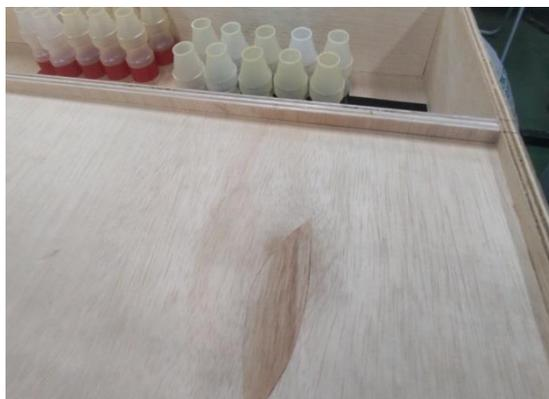
写真7：脱輪防止枠 (高さ10mm)
